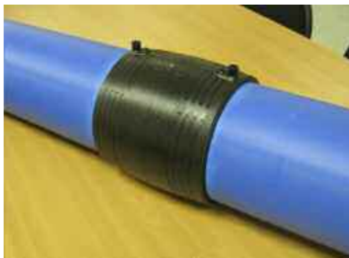
Рисунок 11. Сварка закладными электронагревателями
