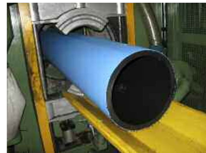
Рисунок 1. Нанесение защитного покрытия методом соэкструзии.
